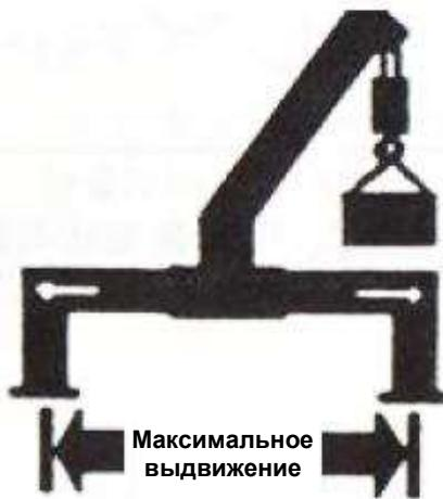
**⚠** При установке выносных опор на грунт используйте деревянные подкладки, обеспечьте устойчивость с обеих сторон в горизонтальном положении и наблюдайте за процессом с передней стороны машины, если кран установлен на неровной или наклонной поверхности.
