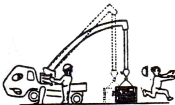
⚠ «Резкое» манипулирования рычагами управления может представлять опасность для людей, находящихся в пределах рабочей зоны. Кроме того, это может вызвать опрокидывание.
