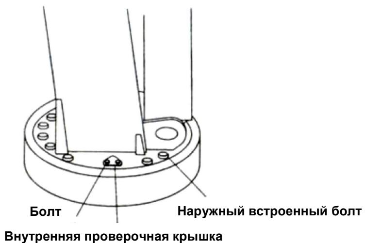
\*Примечание: Указания по проверке затяжки болтов ОПУ
