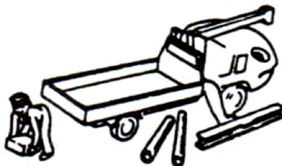
**⚠** Перед началом работы при полностью сложенном оборудовании КМУ (в транспортном положении) проверьте уровень гидравлического масла по масломерному стеклу (между максимальным и минимальным уровнем), и долейте масло при необходимости.
