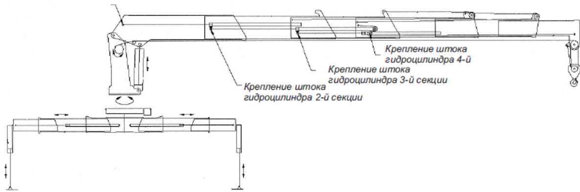
Рис. 6 КМУ модели SS3506. Схема кинематическая.
