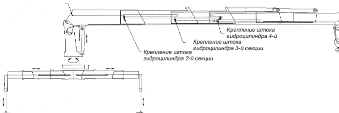
Рис. 6 КМУ модели SS1956. Схема кинематическая.
