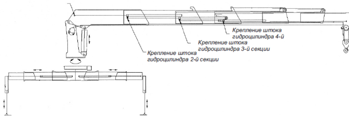
Рис. 6 КМУ модели SS1926. Схема кинематическая.
